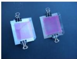
太陽電池の出来上がりです。
